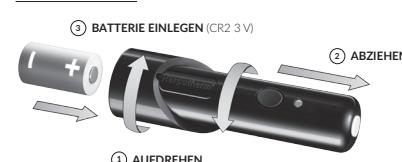
Zum Batteriewechsel muss die Schutzkappe und die Batteriekappe entfernt und nach dem Einlegen der Batterie wieder aufgesetzt werden (siehe Abbildung). Beim Aufsetzen der Batteriekappe ist zu beachten, dass das Logo „herpotherm®“ und der abgeflachte Rand der Batteriekappe dieselbe Orientierung haben, damit das Gehäuse richtig geschlossen werden kann.
